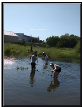
Рис.1 Определение скорости воды в реке и замеры глубин для построения профиля живого сечения
