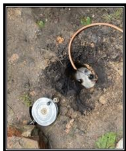
Рис.2 Налив воды в скважину в зоне аэрации
